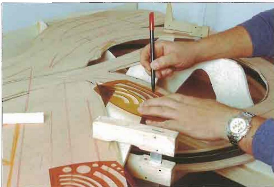
A la izquierda: marque el trayecto del hilo conductor Faller "Car system", con la ayuda de una plantilla y un rotulador color rojo.
