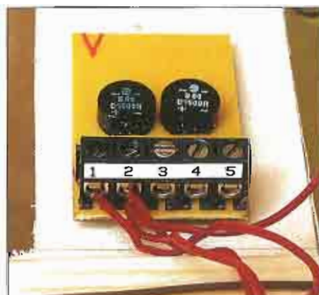
Abajo: Pequeño pero eficaz. El módulo reductor de tensión Helmo. En esta posición reduce la tensión en 1,4 voltios en el recinto de la estación.
