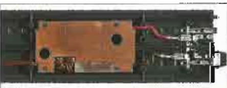
74046 Equipo toma corriente con antiparásitos y protección contra sobre-tensiones
