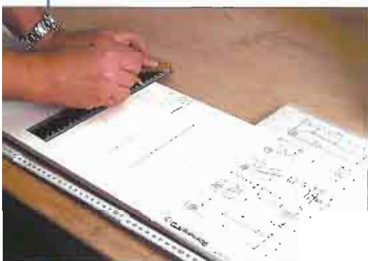
Marcar los soportes transversales meticulosamente según las indicaciones del plano.
