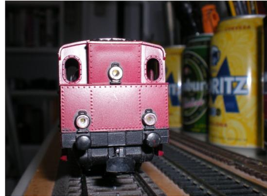
Taladro el foco alto con broca de 1 Mm. y luego con broca de 2 Mm. para centrar bien el agujero e inserto en él un led de 2 Mm. con cuello largo que me proporciona directamente el cristal del foco. Para acristalar los focos bajos he recurrido a una gota de pegamento transparente poco disolvente y queda bastante bien. Lo dejo secar un rato y continúo.
